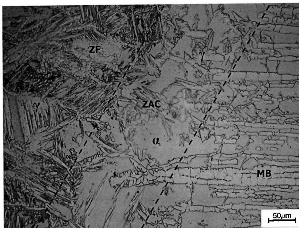
Figura 16 - Microestrutura da Zona Fundida, ZAC e MB do CP1. Ataque ácido oxálico 10%. Aumento 200X
