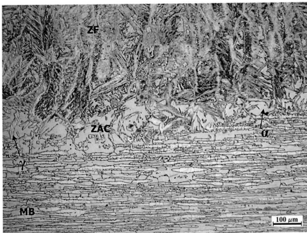
Figura 22 - Microestrutura da ZAC, ZF e MB do CP2. Ataque ácido oxálico 10%. Aumento 100X.
